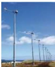
Le modèle « Evance R9000 » représenté ci-contre est une éolienne domestique à axe horizontal de 12m de hauteur pour une puissance nominale de 5 kW (atteinte lors de rafales à 12 m/s). Les données du distributeur CAP ENERGIE font état d'un diamètre du rotor de 5.5 m et l'entrée en rotation s'effectue pour des vents supérieurs à 3 m/s.
