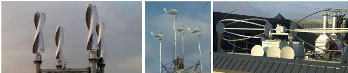
*Eoliennes urbaines de type Savonius (à gauche), Venturi (au milieu) et Darreius (à droite)*
