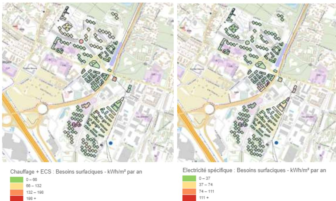
**Figure 4 : Besoins surfaciques en chauffage + ECS (à gauche) et d'électricité spécifique (à droite) par bâtiment (source : PowerDis)**
