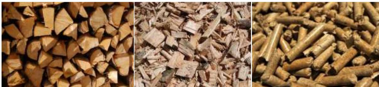
*Bois sous forme de bûches (à gauche), de plaquettes (au milieu) et de granulés (à droite)*
